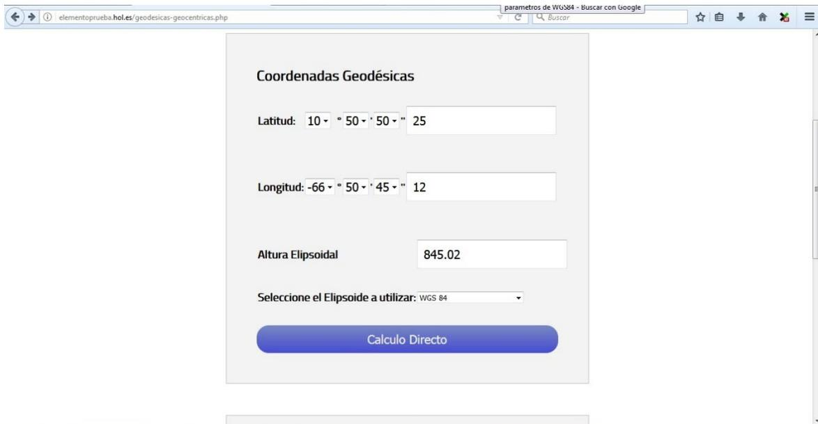
Figura N° 37 Captura de pantalla, Calculo de Coordenadas Geodésicas-Geocéntricas, sentido Directo
